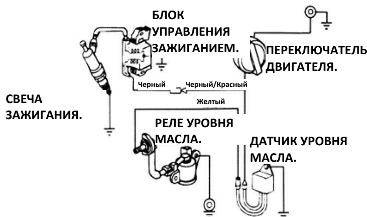
СХЕМА РАЗВОДКИ ДАТЧИКА УРОВНЯ МАСЛА.
