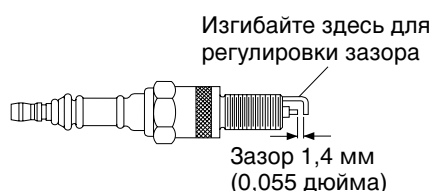
Рис. 12. Регулировка зазора свечи зажигания, нагреватель мощностью 10 кВт
