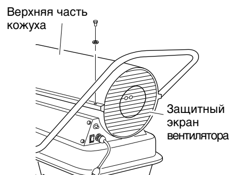
Рис. 8. Снятие верхней части кожуха, нагреватели мощностью 29 и 44 кВт
