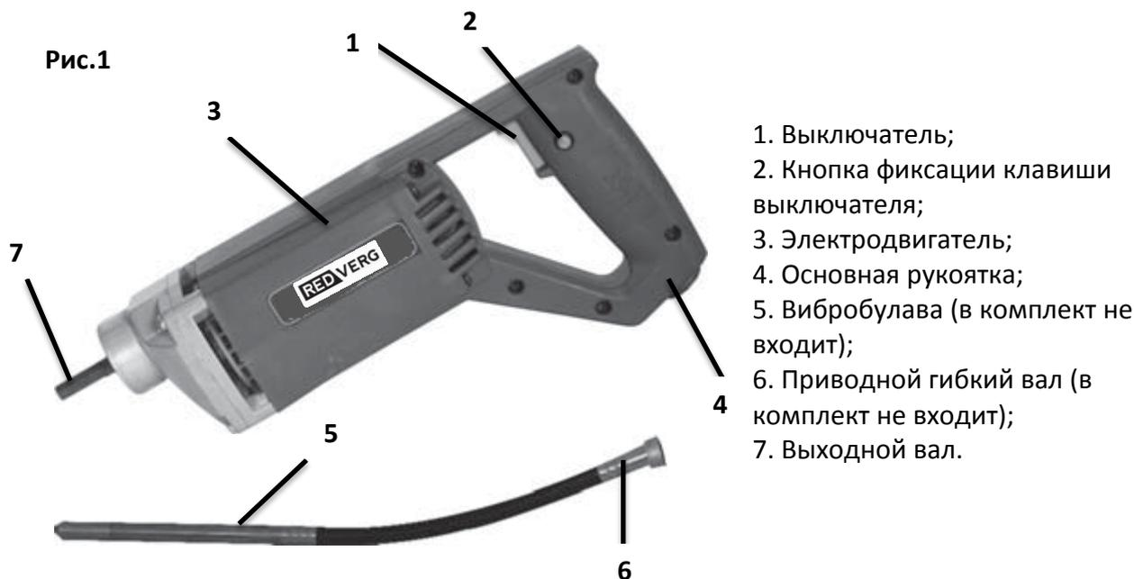
Вибратор состоит из коллекторного двигателя в пластиковом корпусе и вала привода с вибробулавой. Вращение с якоря передаётся через шестерню на выходной вал (7) (рис. 1.), который приводит в действие вал привода (6).
