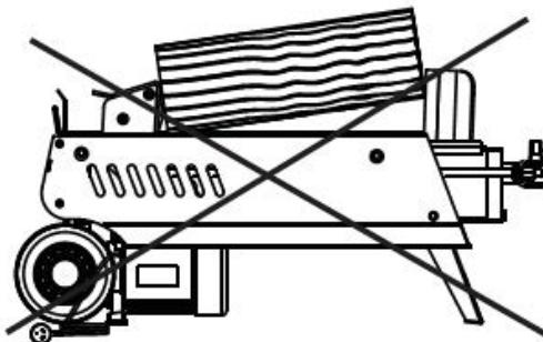
Следует рубить бревно вдоль волокон. Не устанавливать бревно поперек станка для рубки. Это опасно и может нанести серьезный ущерб устройству. Не пытаться разрубить 2 бревна одновременно. Один из них может отлететь и попасть в оператора.
