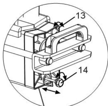
**Перед началом работы дровокольного станка необходимо ослабить стравливающий винт на несколько оборотов, чтобы воздух мог беспрепятственно проникать внутрь масляного резервуара и выходить из него.**
