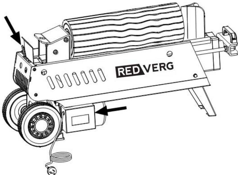
Дровокольный станок оборудован системой управления ZHB, которая предполагает использование оператором обеих рук – левой рукой осуществляется управление рычагом гидроуправления, правой рукой – управление кнопочным переключателем. Дровокольный станок прекращает работу, если не держать его обеими руками. Станок начинает перемещение в исходное положение только после того, как обе руки будут убраны с органов управления.
