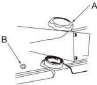
А. Крышка топливного бака В. Указатель уровня топлива
