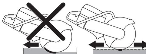
**Резка с помощью дисков с зубцами или твердосплавным режущим полотном во время выполнения спасательных операций**
