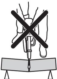
Если диск зажатым или застрянет в зоне отдачи, сила реакции будет толкать устройство вверх и назад к оператору вращательным движением, что может вызвать опасную или даже смертельную травму.
