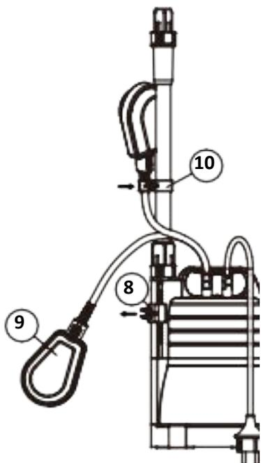
Подсоедините кабель поплавкового выключателя (9) с хомутом крепления (10) (минимальная глубина воды должна составлять 1 мм).
